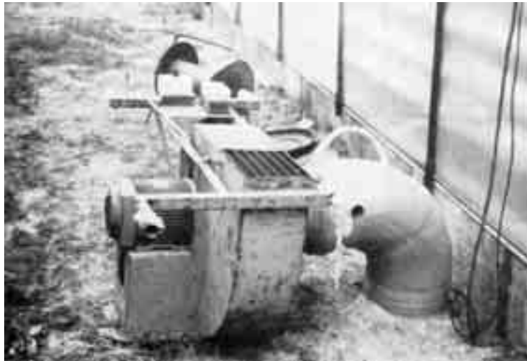
Fig. 4.8 Bij stomen met onderdruk zuigt een ventilator de lucht uit de grond.
