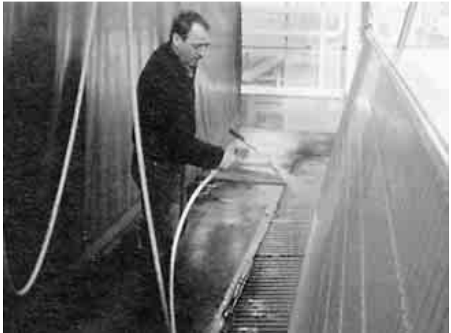
Fig. 2.2 Een kantelconstructie is handig om containers schoon te spuiten.
