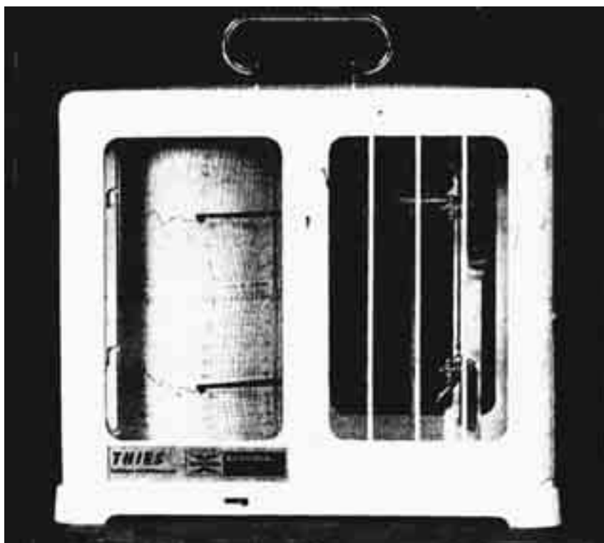
Fig. 3.13 Een thermohygrograaf zet de gemeten waarden in een grafiek.
